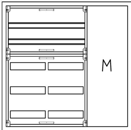
AVB3-5-210-M1 Automatenverteiler, AVB, BxHxT = 800x800x210 Schutzklasse I, IP41, RAL 9016, Aufputz
