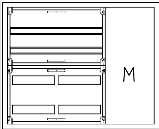
AVB3-4-230-M1-PAutomatenverteiler, AVB, BxHxT = 800x650x230Schutzklasse I, IP54, RAL 7035, AufputzBestehend aus:Gehäuse, Einzeltür mit Schwenkhebel für PHZ, Flansche SF45 (oben) und SF41 (unten), 1x Geräteträger 2-Feld breit 2/2 mit Feldabdeckungen PS, 1x Montageplatte 1-Feld breit
