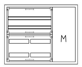
AVB3-4-210-M1-PAutomatenverteiler, AVB, BxHxT = 800x650x210Schutzklasse I, IP41, RAL 9016, AufputzBestehend aus:Gehäuse, Doppeltür mit Drehriegel, Flansche NF1 (oben) und NF2 (unten), 1x Geräteträger 2-Feld breit 2/2 mit Feldabdeckungen PS, 1x Montageplatte 1-Feld breit
