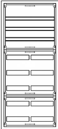
AVB2-8-230 Automatenverteiler, AVB, BxHxT = 550x1250x230 Schutzklasse I, IP54, RAL 7035, Aufputz
