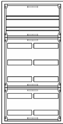
AVB2-7-230 Automatenverteiler, AVB, BxHxT = 550x1100x230 Schutzklasse I, IP54, RAL 7035, Aufputz
