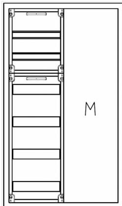
AVB2-6-230-M1 Automatenverteiler, AVB, BxHxT = 550x950x230 Schutzklasse I, IP54, RAL 7035, Aufputz
