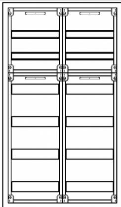
AVB2-6-210-S Automatenverteiler, AVB, BxHxT = 550x950x210 Schutzklasse I, IP41, RAL 9016, Aufputz
