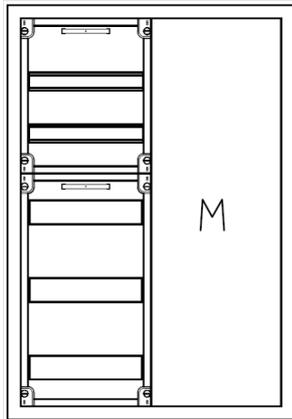
AVB2-5-230-M1-PAutomatenverteiler, AVB, BxHxT = 550x800x230Schutzklasse I, IP54, RAL 7035, AufputzBestehend aus:Gehäuse, Einzeltür mit Schwenkhebel für PHZ, Flansche SF45 (oben) und SF41 (unten), 1x Geräteträger 1-Feld breit 2/3 mit Feldabdeckungen PS, 1x Montageplatte 1-Feld breit
