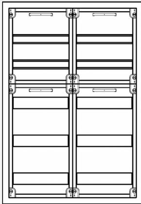
AVB2-5-210-S Automatenverteiler, AVB, BxHxT = 550x800x210 Schutzklasse I, IP41, RAL 9016, Aufputz
