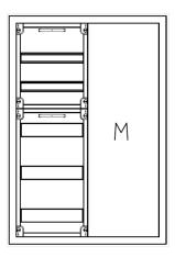
AVB2-5-210-M1-PAutomatenverteiler, AVB, BxHxT = 550x800x210Schutzklasse I, IP41, RAL 9016, AufputzBestehend aus:Gehäuse, Einzeltür mit Drehriegel, Flansche NF1 (oben) und NF2 (unten), 1x Geräteträger 1-Feld breit 2/3 mit Feldabdeckungen PS, 1x Montageplatte 1-Feld breit
