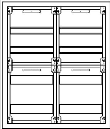
AVB2-4-230-S-PAutomatenverteiler, AVB, BxHxT = 550x650x230 Schutzklasse I, IP54, RAL 7035, Aufputz
