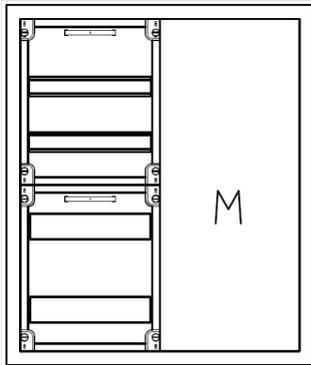
AVB2-4-230-M1-PAutomatenverteiler, AVB, BxHxT = 550x650x230Schutzklasse I, IP54, RAL 7035, AufputzBestehend aus:Gehäuse, Einzeltür mit Schwenkhebel für PHZ, Flansche SF45 (oben) und SF41 (unten), 1x Geräteträger 1-Feld breit 2/2 mit Feldabdeckungen PS, 1x Montageplatte 1-Feld breit
