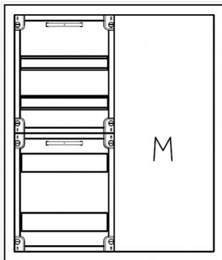
AVB2-4-210-M1-PAutomatenverteiler, AVB, BxHxT = 550x650x210 Schutzklasse I, IP41, RAL 9016, Aufputz Bestehend aus: Gehäuse, Einzeltür mit Drehriegel, Flansche NF1 (oben) und NF2 (unten), 1x Geräteträger 1-Feld breit 2/2 mit Feldabdeckungen PS, 1x Montageplatte 1-Feld breit
