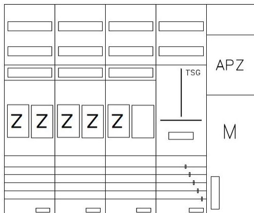
AEZ52-230-145, eHZ-Zählerverteilung nach VDE 0603, DIN43870, AR-N 4101:2015 für den Innenbereich für Wandbefestigung AP/UP, Fabr. Alphatec, BxHxT [mm] = 1300x1100x230, Schutzklasse II, IP54, RAL 7035, Bestehend aus: Gehäuse, Einzel- bzw. Doppeltür mit Drehriegel, Flansche SF45 (oben) und SF41 (unten) und Berührungsschutzabdeckungen, aufgebaut wie folgt: 5xZählerplatz, TSG, APZ in Medienfeld, komplett zusammengebaut und verdrahtet gemäß VNB.0126
