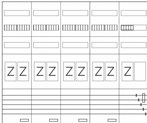
AEZ52-230-140, eHZ-Zählerverteilung nach VDE 0603, DIN43870, AR-N 4101:2015 für den Innenbereich für Wandbefestigung AP/UP, Fabr. Alphatec, BxHxT [mm] = 1300x1100x230, Schutzklasse II, IP54, RAL 7035, Bestehend aus: Gehäuse, Doppeltür mit Schwenkhebel für Profilhalbzylinder, Flansche SF45 (oben) und SF41 (unten) und Berührungsschutzabdeckungen, aufgebaut wie folgt: 9x Zählerplatz, 1x TSG-Platte, geeignet für TSG-Hutschienenmontage: ja, komplett zusammengebaut und verdrahtet gemäß VNB.0001
