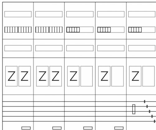
AEZ52-230-138, eHZ-Zählerverteilung nach VDE 0603, DIN43870, AR-N 4101:2015 für den Innenbereich für Wandbefestigung AP/UP, Fabr. Alphatec, BxHxT [mm] = 1300x1100x230, Schutzklasse II, IP54, RAL 7035, Bestehend aus: Gehäuse, Doppeltür mit Schwenkhebel für Profilhalbzylinder, Flansche SF45 (oben) und SF41 (unten) und Berührungsschutzabdeckungen, aufgebaut wie folgt: 7x Zählerplatz, 1x TSG-Platte, geeignet für TSG-Hutschienenmontage: ja, komplett zusammengebaut und verdrahtet gemäß VNB.0001
