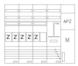
AEZ52-210-145, eHZ-Zählerverteilungnach VDE 0603, DIN43870, AR-N 4101:2015 für den Innenbereich für Wandbefestigung AP/UP, Fabr. Alphatec, BxHxT [mm] = 1300x1100x210, Schutzklasse II, IP41, RAL 9016, Bestehend aus: Gehäuse, Einzel- bzw. Doppeltür mit Drehriegel, Flansche NF1 (oben) und NF2 (unten) und Berührungsschutzabdeckungen, aufgebaut wie folgt: 5xZählerplatz, TSG, APZ in Medienfeld, komplett zusammengebaut und verdrahtet gemäß VNB.0038
