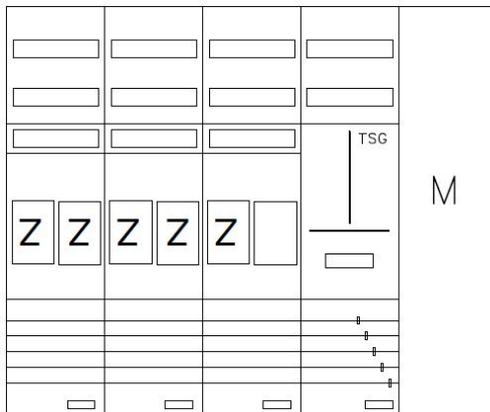
AEZ52-210-144, eHZ-Zählerverteilung nach VDE 0603, DIN43870, AR-N 4101:2015 für den Innenbereich für Wandbefestigung AP/UP, Fabr. Alphatec, BxHxT [mm] = 1300x1100x210, Schutzklasse II, IP41, RAL 9016, Bestehend aus: Gehäuse, Einzel- bzw. Doppeltür mit Drehriegel, Flansche NF1 (oben) und NF2 (unten) und Berührungsschutzabdeckungen, aufgebaut wie folgt: 5xZählerplatz, TSG, Medienfeld, externer APZ erforderlich, komplett zusammengebaut und verdrahtet gemäß VNB.0037
