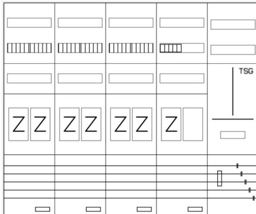
AEZ52-210-128, eHZ-Zählerverteilung nach VDE 0603, DIN43870, AR-N 4101:2015 für den Innenbereich für Wandbefestigung AP/UP, Fabr. Alphatec, BxHxT [mm] = 1300x1100x210, Schutzklasse II, IP41, RAL 9016, Bestehend aus: Gehäuse, Doppeltür mit Drehriegel, Flansche NF1 (oben) und NF2 (unten) und Berührungsschutzabdeckungen, aufgebaut wie folgt: 7x Zählerplatz, 1x TSG-Platte, geeignet für TSG-Hutschienenmontage: nein, komplett zusammengebaut und verdrahtet gemäß VNB.0001
