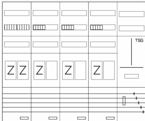
AEZ52-210-126, eHZ-Zählerverteilung nach VDE 0603, DIN43870, AR-N 4101:2015 für den Innenbereich für Wandbefestigung AP/UP, Fabr. Alphatec, BxHxT [mm] = 1300x1100x210, Schutzklasse II, IP41, RAL 9016, Bestehend aus: Gehäuse, Doppeltür mit Drehriegel, Flansche NF1 (oben) und NF2 (unten) und Berührungsschutzabdeckungen, aufgebaut wie folgt: 5x Zählerplatz, 1x TSG-Platte, geeignet für TSG-Hutschienenmontage: nein, komplett zusammengebaut und verdrahtet gemäß VNB.0001
