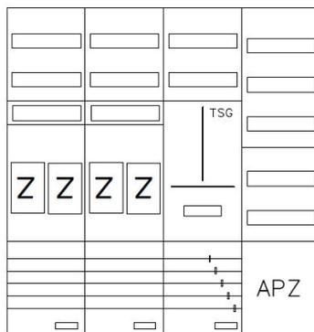
AEZ42-230-088, eHZ-Zählerverteilung nach VDE 0603, DIN43870, AR-N 4101:2015 für den Innenbereich für Wandbefestigung AP/UP, Fabr. Alphatec, BxHxT [mm] = 1050x1100x230, Schutzklasse II, IP54, RAL 7035, Bestehend aus: Gehäuse, Einzel- bzw. Doppeltür mit Drehriegel, Flansche SF45 (oben) und SF41 (unten) und Berührungsschutzabdeckungen, aufgebaut wie folgt: 4xZählerplatz, TSG, Verteilerfeld (12TE), APZ in Verteilerfeld, Verteilerfeld (12TE), komplett zusammengebaut und verdrahtet gemäß VNB.0113
