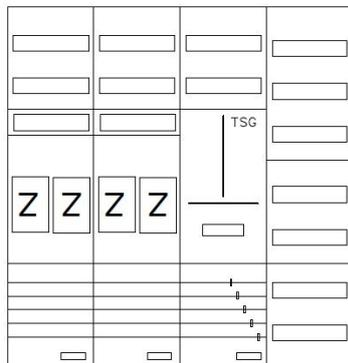
AEZ42-230-087, eHZ-Zählerverteilung nach VDE 0603, DIN43870, AR-N 4101:2015 für den Innenbereich für Wandbefestigung AP/UP, Fabr. Alphatec, BxHxT [mm] = 1050x1100x230, Schutzklasse II, IP54, RAL 7035, Bestehend aus: Gehäuse, Einzel- bzw. Doppeltür mit Drehriegel, Flansche SF45 (oben) und SF41 (unten) und Berührungsschutzabdeckungen, aufgebaut wie folgt: 4xZählerplatz, TSG, Verteilerfeld (12TE), Verteilerfeld (12TE), externer APZ erforderlich, komplett zusammengebaut und verdrahtet gemäß VNB.0112
