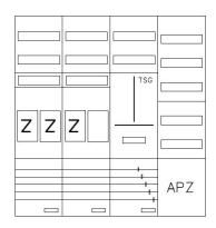
AEZ42-230-084, eHZ-Zählerverteilungnach VDE 0603, DIN43870, AR-N 4101:2015 für den Innenbereich für Wandbefestigung AP/UP, Fabr. Alphatec, BxHxT [mm] = 1050x1100x230, Schutzklasse II, IP54, RAL 7035, Bestehend aus: Gehäuse, Einzel- bzw. Doppeltür mit Drehriegel, Flansche SF45 (oben) und SF41 (unten) und Berührungsschutzabdeckungen, aufgebaut wie folgt: 3xZählerplatz, TSG, Verteilerfeld (12TE), APZ in Verteilerfeld, Verteilerfeld (12TE), komplett zusammengebaut und verdrahtet gemäß VNB.0109
