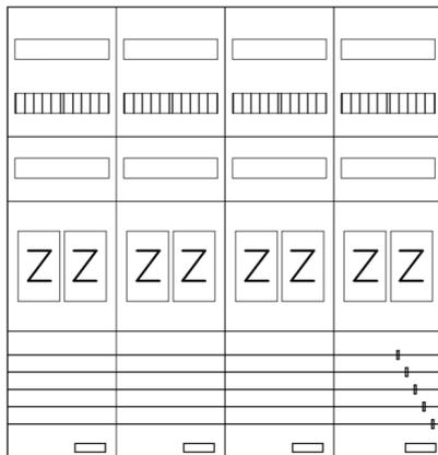
AEZ42-230-080, eHZ-Zählerverteilung nach VDE 0603, DIN43870, AR-N 4101:2015 für den Innenbereich für Wandbefestigung AP/UP, Fabr. Alphatec, BxHxT [mm] = 1050x1100x230, Schutzklasse II, IP54, RAL 7035, Bestehend aus: Gehäuse, Doppeltür mit Schwenkhebel für Profilhalbzylinder, Flansche SF45 (oben) und SF41 (unten) und Berührungsschutzabdeckungen, aufgebaut wie folgt: 8x Zählerplatz, komplett zusammengebaut und verdrahtet gemäß VNB.0001
