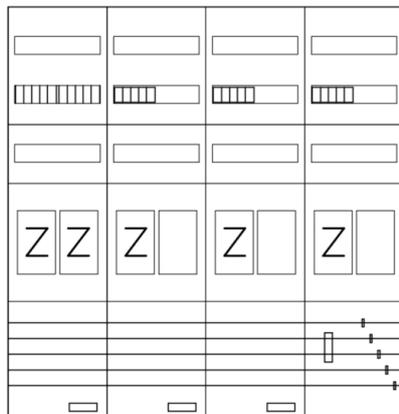
AEZ42-230-075, eHZ-Zählerverteilung nach VDE 0603, DIN43870, AR-N 4101:2015 für den Innenbereich für Wandbefestigung AP/UP, Fabr. Alphatec, BxHxT [mm] = 1050x1100x230, Schutzklasse II, IP54, RAL 7035, Bestehend aus: Gehäuse, Doppeltür mit Schwenkhebel für Profilhalbzylinder, Flansche SF45 (oben) und SF41 (unten) und Berührungsschutzabdeckungen, aufgebaut wie folgt: 5x Zählerplatz, 1x TSG-Platte, geeignet für TSG-Hutschienenmontage: ja, komplett zusammengebaut und verdrahtet gemäß VNB.0001
