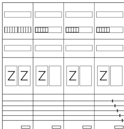
AEZ42-230-074, eHZ-Zählerverteilung nach VDE 0603, DIN43870, AR-N 4101:2015 für den Innenbereich für Wandbefestigung AP/UP, Fabr. Alphatec, BxHxT [mm] = 1050x1100x230, Schutzklasse II, IP54, RAL 7035, Bestehend aus: Gehäuse, Doppeltür mit Schwenkhebel für Profilhalbzylinder, Flansche SF45 (oben) und SF41 (unten) und Berührungsschutzabdeckungen, aufgebaut wie folgt: 5x Zählerplatz, komplett zusammengebaut und verdrahtet gemäß VNB.0001
