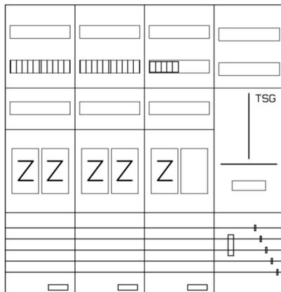
AEZ42-230-070, eHZ-Zählerverteilung nach VDE 0603, DIN43870, AR-N 4101:2015 für den Innenbereich für Wandbefestigung AP/UP, Fabr. Alphatec, BxHxT [mm] = 1050x1100x230, Schutzklasse II, IP54, RAL 7035, Bestehend aus: Gehäuse, Doppeltür mit Schwenkhebel für Profilhalbzylinder, Flansche SF45 (oben) und SF41 (unten) und Berührungsschutzabdeckungen, aufgebaut wie folgt: 5x Zählerplatz, 1x TSG-Platte, geeignet für TSG-Hutschienenmontage: nein, komplett zusammengebaut und verdrahtet gemäß VNB.0001
