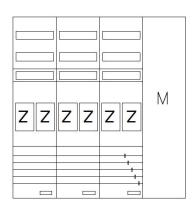
AEZ42-210-091, eHZ-Zählerverteilungnach VDE 0603, DIN43870, AR-N 4101:2015 für den Innenbereich für Wandbefestigung AP/UP, Fabr. Alphatec, BxHxT [mm] = 1050x1100x210, Schutzklasse II, IP41, RAL 9016, Bestehend aus: Gehäuse, Einzel- bzw. Doppeltür mit Drehriegel, Flansche NF1 (oben) und NF2 (unten) und Berührungsschutzabdeckungen, aufgebaut wie folgt: 6xZählerplatz, Medienfeld, externer APZ erforderlich, komplett zusammengebaut und verdrahtet gemäß VNB.0028
