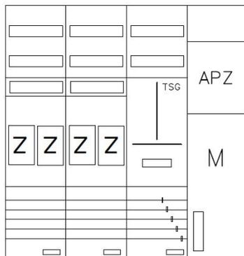
AEZ42-210-086, eHZ-Zählerverteilung nach VDE 0603, DIN43870, AR-N 4101:2015 für den Innenbereich für Wandbefestigung AP/UP, Fabr. Alphatec, BxHxT [mm] = 1050x1100x210, Schutzklasse II, IP41, RAL 9016, Bestehend aus: Gehäuse, Einzel- bzw. Doppeltür mit Drehriegel, Flansche NF1 (oben) und NF2 (unten) und Berührungsschutzabdeckungen, aufgebaut wie folgt: 4xZählerplatz, TSG, APZ in Medienfeld, komplett zusammengebaut und verdrahtet gemäß VNB.0023
