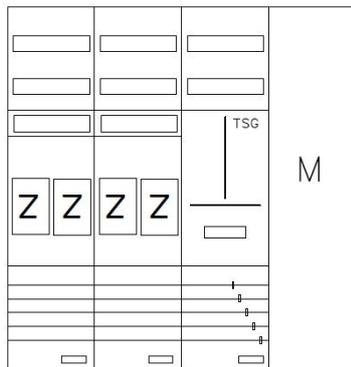
AEZ42-210-085, eHZ-Zählerverteilung nach VDE 0603, DIN43870, AR-N 4101:2015 für den Innenbereich für Wandbefestigung AP/UP, Fabr. Alphatec, BxHxT [mm] = 1050x1100x210, Schutzklasse II, IP41, RAL 9016, Bestehend aus: Gehäuse, Einzel- bzw. Doppeltür mit Drehriegel, Flansche NF1 (oben) und NF2 (unten) und Berührungsschutzabdeckungen, aufgebaut wie folgt: 4xZählerplatz, TSG, Medienfeld, externer APZ erforderlich, komplett zusammengebaut und verdrahtet gemäß VNB.0022
