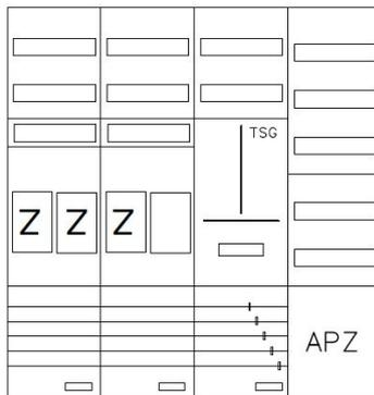
AEZ42-210-084, eHZ-Zählerverteilung nach VDE 0603, DIN43870, AR-N 4101:2015 für den Innenbereich für Wandbefestigung AP/UP, Fabr. Alphatec, BxHxT [mm] = 1050x1100x210, Schutzklasse II, IP41, RAL 9016, Bestehend aus: Gehäuse, Einzel- bzw. Doppeltür mit Drehriegel, Flansche NF1 (oben) und NF2 (unten) und Berührungsschutzabdeckungen, aufgebaut wie folgt: 3xZählerplatz, TSG, Verteilerfeld (12TE), APZ in Verteilerfeld, komplett zusammengesetzt und verdrahtet gemäß VNB.0021
