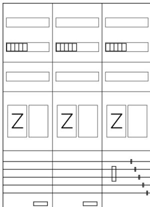
AEZ32-230-036, eHZ-Zählerverteilung nach VDE 0603, DIN43870, AR-N 4101:2015 für den Innenbereich für Wandbefestigung AP/UP, Fabr. Alphatec, BxHxT [mm] = 800x1100x230, Schutzklasse II, IP54, RAL 7035, Bestehend aus: Gehäuse, Doppeltür mit Schwenkhebel für Profilhalbzylinder, Flansche SF45 (oben) und SF41 (unten) und Berührungsschutzabdeckungen, aufgebaut wie folgt: 3x Zählerplatz, 1x TSG-Platte, geeignet für TSG-Hutschienenmontage: ja, komplett zusammengebaut und verdrahtet gemäß VNB.0001
