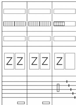
AEZ32-230-033, eHZ-Zählerverteilung nach VDE 0603, DIN43870, AR-N 4101:2015 für den Innenbereich für Wandbefestigung AP/UP, Fabr. Alphatec, BxHxT [mm] = 800x1100x230, Schutzklasse II, IP54, RAL 7035, Bestehend aus: Gehäuse, Doppeltür mit Schwenkhebel für Profilhalbzylinder, Flansche SF45 (oben) und SF41 (unten) und Berührungsschutzabdeckungen, aufgebaut wie folgt: 5x Zählerplatz, 1x TSG-Platte, geeignet für TSG-Hutschienenmontage: ja, komplett zusammengesetzt und verdrahtet gemäß VNB.0001
