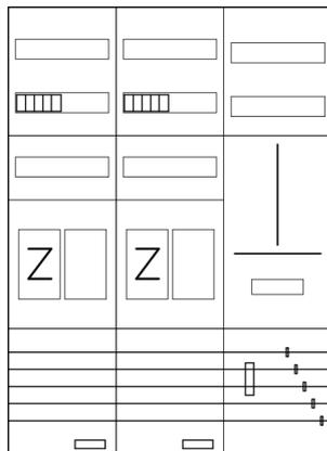
AEZ32-230-030, eHZ-Zählerverteilung nach VDE 0603, DIN43870, AR-N 4101:2015 für den Innenbereich für Wandbefestigung AP/UP, Fabr. Alphatec, BxHxT [mm] = 800x1100x230, Schutzklasse II, IP54, RAL 7035, Bestehend aus: Gehäuse, Doppeltür mit Schwenkhebel für Profilhalbzylinder, Flansche SF45 (oben) und SF41 (unten) und Berührungsschutzabdeckungen, aufgebaut wie folgt: 2x Zählerplatz, 1x TSG-Platte, geeignet für TSG-Hutschienenmontage: nein, komplett zusammengebaut und verdrahtet gemäß VNB.0001
