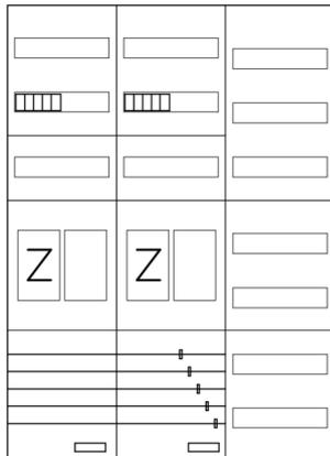
AEZ32-230-013, eHZ-Zählerverteilung nach VDE 0603, DIN43870, AR-N 4101:2015 für den Innenbereich für Wandbefestigung AP/UP, Fabr. Alphatec, BxHxT [mm] = 800x1100x230, Schutzklasse II, IP54, RAL 7035, Bestehend aus: Gehäuse, Doppeltür mit Schwenkhebel für Profilhalbzylinder, Flansche SF45 (oben) und SF41 (unten) und Berührungsschutzabdeckungen, aufgebaut wie folgt: 2x Zählerplatz, 7x Hutschienen in Verteilerfeld 1 (12TE), komplett zusammengebaut und verdrahtet gemäß VNB.0001
