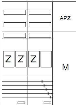
AEZ32-210-047, eHZ-Zählerverteilung nach VDE 0603, DIN43870, AR-N 4101:2015 für den Innenbereich für Wandbefestigung AP/UP, Fabr. Alphatec, BxHxT [mm] = 800x1100x210, Schutzklasse II, IP41, RAL 9016, Bestehend aus: Gehäuse, Einzel- bzw. Doppeltür mit Drehriegel, Flansche NF1 (oben) und NF2 (unten) und Berührungsschutzabdeckungen, aufgebaut wie folgt: 3xZählerplatz, APZ in Medienfeld, geeignet für TSG Hutschienenmontage, komplett zusammengebaut und verdrahtet gemäß VNB.0017
