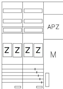
AEZ32-210-043, eHZ-Zählerverteilung nach VDE 0603, DIN43870, AR-N 4101:2015 für den Innenbereich für Wandbefestigung AP/UP, Fabr. Alphatec, BxHxT [mm] = 800x1100x210, Schutzklasse II, IP41, RAL 9016, Bestehend aus: Gehäuse, Einzel- bzw. Doppeltür mit Drehriegel, Flansche NF1 (oben) und NF2 (unten) und Berührungsschutzabdeckungen, aufgebaut wie folgt: 4xZählerplatz, APZ in Medienfeld, komplett zusammengebaut und verdrahtet gemäß VNB.0013
