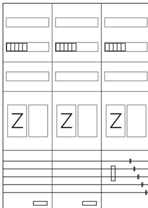
AEZ32-210-036, eHZ-Zählerverteilung nach VDE 0603, DIN43870, AR-N 4101:2015 für den Innenbereich für Wandbefestigung AP/UP, Fabr. Alphatec, BxHxT [mm] = 800x1100x210, Schutzklasse II, IP41, RAL 9016, Bestehend aus: Gehäuse, Doppeltür mit Drehriegel, Flansche NF1 (oben) und NF2 (unten) und Berührungsschutzabdeckungen, aufgebaut wie folgt: 3x Zählerplatz, 1x TSG-Platte, geeignet für TSG-Hutschienenmontage: ja, komplett zusammengebaut und verdrahtet gemäß VNB.0001
