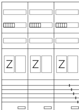
AEZ32-210-035, eHZ-Zählerverteilung nach VDE 0603, DIN43870, AR-N 4101:2015 für den Innenbereich für Wandbefestigung AP/UP, Fabr. Alphatec, BxHxT [mm] = 800x1100x210, Schutzklasse II, IP41, RAL 9016, Bestehend aus: Gehäuse, Doppeltür mit Drehriegel, Flansche NF1 (oben) und NF2 (unten) und Berührungsschutzabdeckungen, aufgebaut wie folgt: 3x Zählerplatz, komplett zusammengebaut und verdrahtet gemäß VNB.0001
