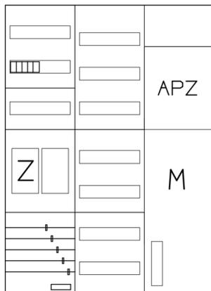
AEZ32-210-029, eHZ-Zählerverteilung nach VDE 0603, DIN43870, AR-N 4101:2015 für den Innenbereich für Wandbefestigung AP/UP, Fabr. Alphatec, BxHxT [mm] = 800x1100x210, Schutzklasse II, IP41, RAL 9016, Bestehend aus: Gehäuse, Doppeltür mit Drehriegel, Flansche NF1 (oben) und NF2 (unten) und Berührungsschutzabdeckungen, aufgebaut wie folgt: 1x Zählerplatz, 7x Hutschienen in Verteilerfeld 1 (12TE), 1x Medienfeld 1 Feld breit inkl. APZ, komplett zusammengebaut und verdrahtet gemäß VNB.0001
