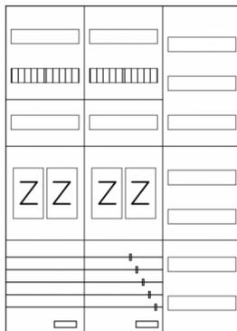
AEZ32-210-011, eHZ-Zählerverteilung nach VDE 0603, DIN43870, AR-N 4101:2015 für den Innenbereich für Wandbefestigung AP/UP, Fabr. Alphatec, BxHxT [mm] = 800x1100x210, Schutzklasse II, IP41, RAL 9016, Bestehend aus: Gehäuse, Doppeltür mit Drehriegel, Flansche NF1 (oben) und NF2 (unten) und Berührungsschutzabdeckungen, aufgebaut wie folgt: 4x Zählerplatz, 7x Hutschienen in Verteilerfeld 1 (12TE), komplett zusammengebaut und verdrahtet gemäß VNB.0001
