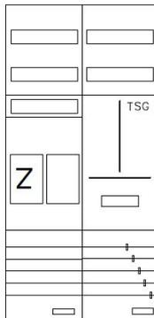
AEZ22-230-018, eHZ-Zählerverteilung nach VDE 0603, DIN43870, AR-N 4101:2015 für den Innenbereich für Wandbefestigung AP/UP, Fabr. Alphatec, BxHxT [mm] = 550x1100x230, Schutzklasse II, IP54, RAL 7035, Bestehend aus: Gehäuse, Einzel- bzw. Doppeltür mit Drehriegel, Flansche SF45 (oben) und SF41 (unten) und Berührungsschutzabdeckungen, aufgebaut wie folgt: 1xZählerplatz, TSG, externer APZ erforderlich, komplett zusammengebaut und verdrahtet gemäß VNB.0096
