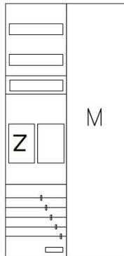
AEZ22-230-016, eHZ-Zählerverteilung nach VDE 0603, DIN43870, AR-N 4101:2015 für den Innenbereich für Wandbefestigung AP/UP, Fabr. Alphatec, BxHxT [mm] = 550x1100x230, Schutzklasse II, IP54, RAL 7035, Bestehend aus: Gehäuse, Einzel- bzw. Doppeltür mit Drehriegel, Flansche SF45 (oben) und SF41 (unten) und Berührungsschutzabdeckungen, aufgebaut wie folgt: 1xZählerplatz, Medienfeld, externer APZ erforderlich, komplett zusammengebaut und verdrahtet gemäß VNB.0094
