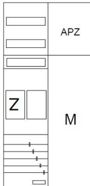
AEZ22-210-017, eHZ-Zählerverteilung nach VDE 0603, DIN43870, AR-N 4101:2015 für den Innenbereich für Wandbefestigung AP/UP, Fabr. Alphatec, BxHxT [mm] = 550x1100x210, Schutzklasse II, IP41, RAL 9016, Bestehend aus: Gehäuse, Einzel- bzw. Doppeltür mit Drehriegel, Flansche NF1 (oben) und NF2 (unten) und Berührungsschutzabdeckungen, aufgebaut wie folgt: 1xZählerplatz, APZ in Medienfeld, geeignet für TSG Hutschienenmontage, komplett zusammengebaut und verdrahtet gemäß VNB.0007
