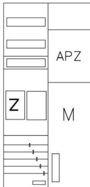
AEZ22-210-012, eHZ-Zählerverteilung nach VDE 0603, DIN43870, AR-N 4101:2015 für den Innenbereich für Wandbefestigung AP/UP, Fabr. Alphatec, BxHxT [mm] = 550x1100x210, Schutzklasse II, IP41, RAL 9016, Bestehend aus: Gehäuse, Einzel- bzw. Doppeltür mit Drehriegel, Flansche NF1 (oben) und NF2 (unten) und Berührungsschutzabdeckungen, aufgebaut wie folgt: 1xZählerplatz, TSG, APZ in Medienfeld, geeignet für TSG Hutschienenmontage, komplett zusammengebaut und verdrahtet gemäß VNB.0002
