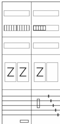
AEZ22-210-006, eHZ-Zählerverteilung nach VDE 0603, DIN43870, AR-N 4101:2015 für den Innenbereich für Wandbefestigung AP/UP, Fabr. Alphatec, BxHxT [mm] = 550x1100x210, Schutzklasse II, IP41, RAL 9016, Bestehend aus: Gehäuse, Einzeltür mit Drehriegel, Flansche NF1 (oben) und NF2 (unten) und Berührungsschutzabdeckungen, aufgebaut wie folgt: 3x Zählerplatz, 1x TSG-Platte, geeignet für TSG-Hutschienenmontage: ja, komplett zusammengebaut und verdrahtet gemäß VNB.0001
