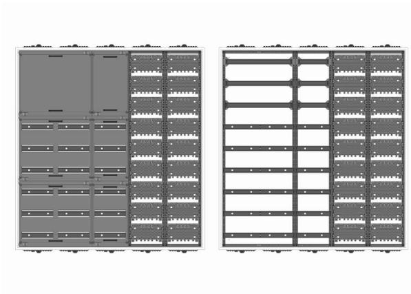
UVK5-9-210-M2 Automatenverteiler, UVK, BxHxT = 1300x1400x210 Schutzklasse II, IP41, RAL 9016, Unterputz Bestehend aus: Gehäuse, Doppeltür mit Drehriegel, Flansche NF1 (oben) und NF2 (unten), 1x Geräteträger 2-Feld breit 3/6 mit Feldabdeckungen PRL, 1x Geräteträger 1-Feld breit 3/6 mit Feldabdeckungen PRL, 1x Montageplatte 2-Feld breit
