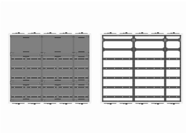
UVK5-7-210-S Automatenverteiler, UVK, BxHxT = 1300x1100x210 Schutzklasse II, IP41, RAL 9016, Unterputz Bestehend aus: Gehäuse, Doppeltür mit Drehriegel, Flansche NF1 (oben) und NF2 (unten), 2x Geräteträger 2-Feld breit 2/5 mit Feldabdeckungen PRL, 1x Geräteträger 1-Feld breit 2/5 mit Feldabdeckungen PRL
