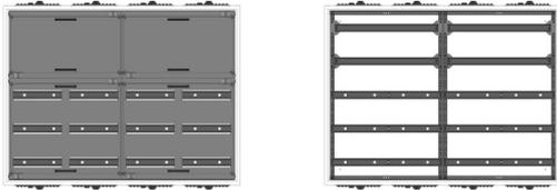
UVK4-5-210 Automatenverteiler, UVK, BxHxT = 1050x800x210 Schutzklasse II, IP41, RAL 9016, Unterputz Bestehend aus: Gehäuse, Doppeltür mit Drehriegel, Flansche NF1 (oben) und NF2 (unten), 2x Geräteträger 2-Feld breit 2/3 mit Feldabdeckungen PRL
