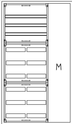
UVK3-9-210-M1-PAutomatenverteiler, UVK, BxHxT = 800x1400x210Schutzklasse II, IP41, RAL 9016, UnterputzBestehend aus:Gehäuse, Doppeltür mit Drehriegel, Flansche NF1 (oben) und NF2 (unten), 1x Geräteträger 2-Feld breit 3/6 mit Feldabdeckungen PS, 1x Montageplatte 1-Feld breit
